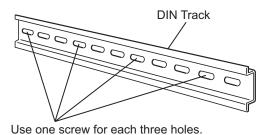
• Using an NS 35/7,5 PERF or NS 35/15 PERF DIN Track
